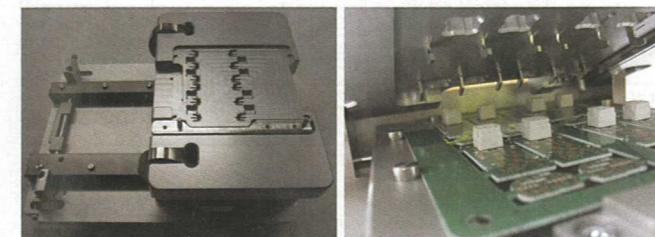
基盤の隙間を精密につかみ回転させる治具
